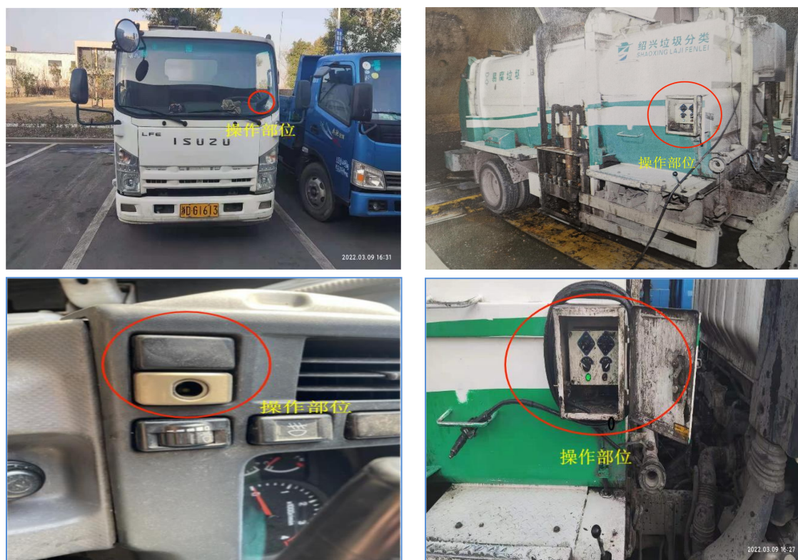
组图2 海德牌餐厨收运车卸料作业驾驶室内和室外操作装置
